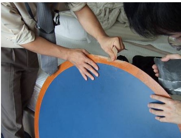
ペーパーをあてて接着面を平滑に整える。
