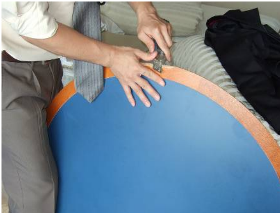
木繊維のササクレが目立つ箇所を除去。 十分な補修面を確保。
